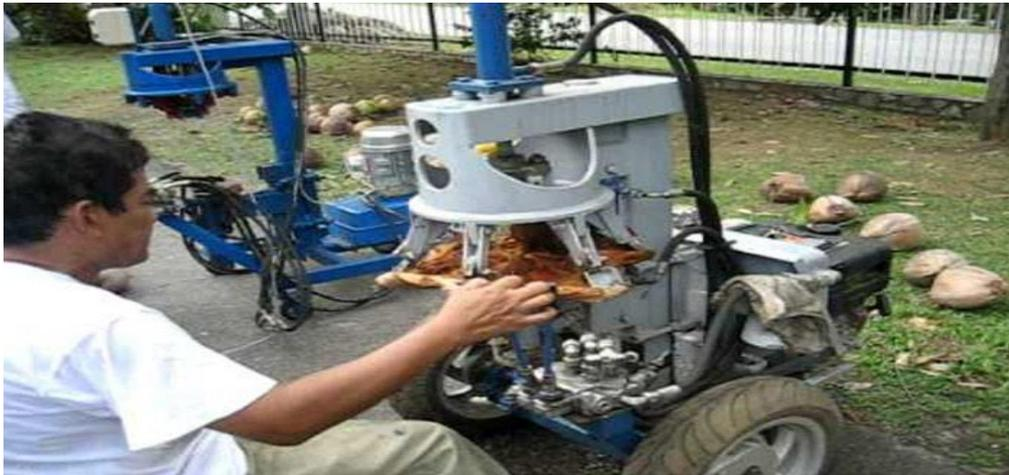
Gambar .5. Mesin Pengupas Hidrolis Otomatis
