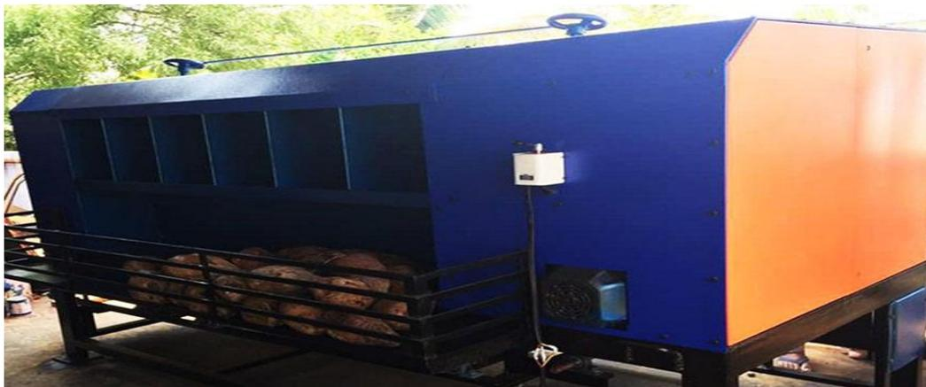
*Gambar. 6 Mesin Pengupas dengan Sistem Pneumatik*
