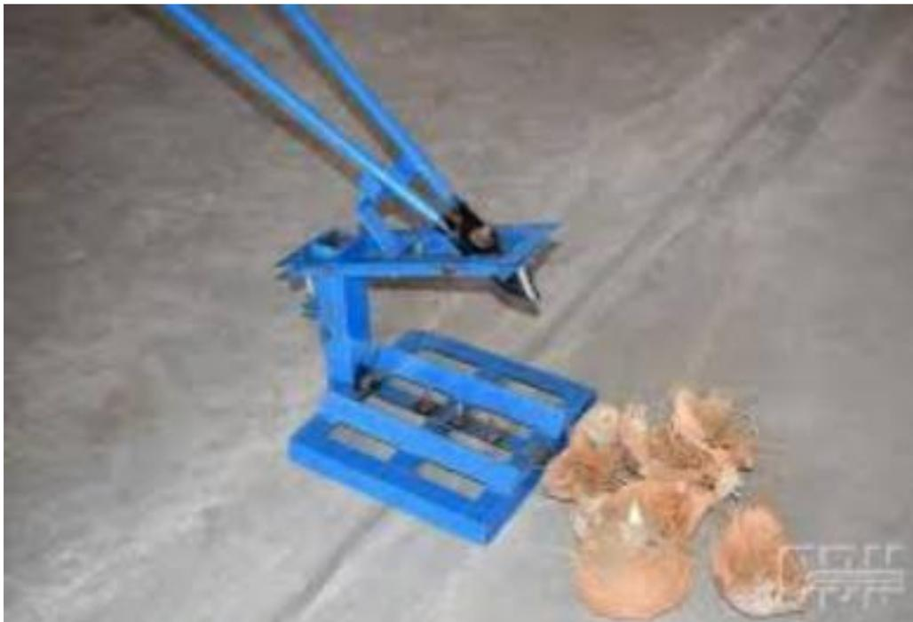
*Gambar .9 Alat Pengupas Tabok Kelapa Kering*
