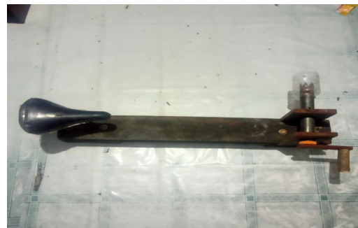
Gambar 13 Alat pelepas biji jagung
