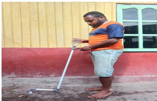
Gambar 8. Desain Alat Tanam Jagung Manual Siap Untuk di Aplikasikan Dilapangan
