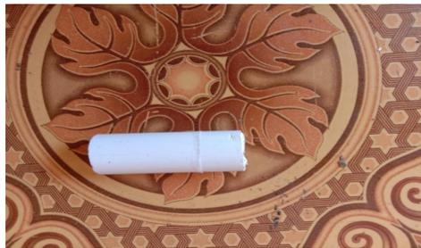
*Gambar 5. Pipa 1 inci, 6 cm, sebagai penentuan jarak antar lubang benih agung*
