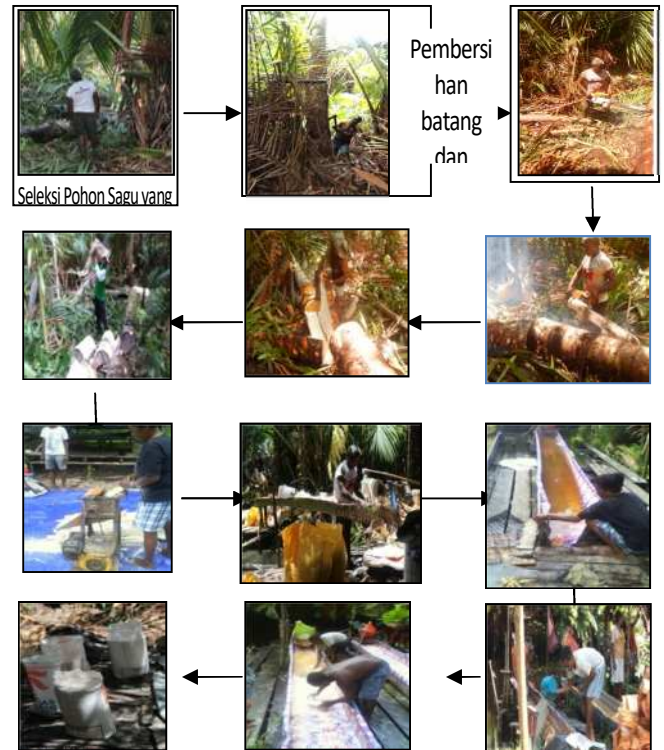
Gambar 1. Bagan Alir dan Proses Pengolahan Sagu Di Distrik Makimi dan Distrik Yaro
